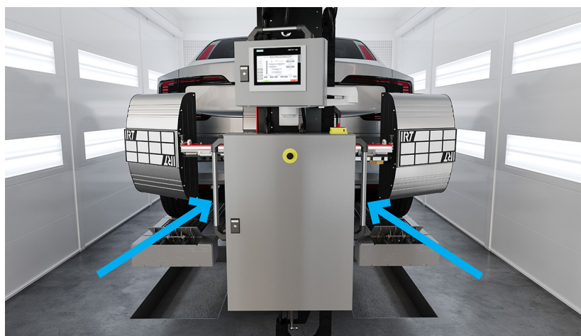
Billede ovenfor: Brug kun de angivne håndtag på overliggeren til at flytte IRT ICure manuelt.
