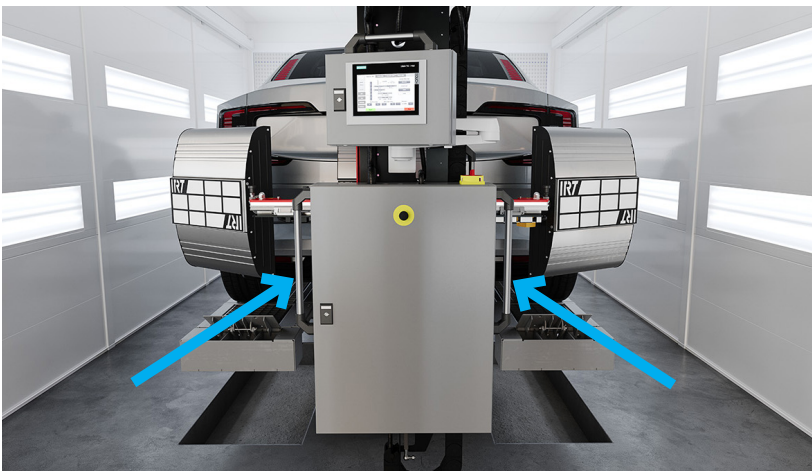
Abbildung oben: Verwenden Sie beim manuellen Bewegen von ICure ausschließlich die am Hauptrahmen gekennzeichneten Griffe.
