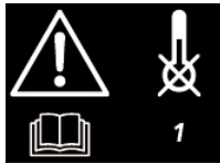
Fehlercode 1: Pyrometer defekt
