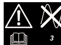
Code Erreur 3 : Fréquence incorrecte
