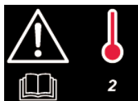
Code Erreur 2 : Si la température à l'intérieur de l'unité de commande s'élève au-dessus de 65°C/149°F, l'appareil s'éteint. Réinitialisation automatique lorsque la température redescend en dessous de 55°C/131°F.
