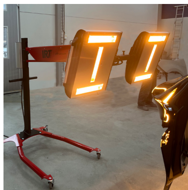
Unika IRT IR-lampor med guldpläterade reflektorer.
