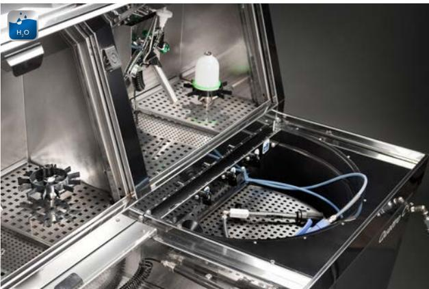
Brosse lavante et pistolet de rinçage avec la solution aqueuse recyclée. (Eau du robinet en option.) Le processus de filtration sépare et sèche les résidus de peinture pour simplifier le traitement des déchets.
