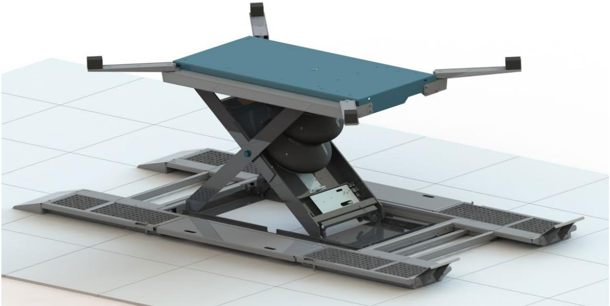
Herkules AirgoMatic Pro 3513 DUO-11 - auf Rädern oder radfrei anheben; Installation auf dem Boden aufliegend
