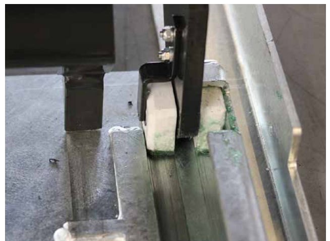
Herkules AirgoMatic Pro 3513-11 – stabil und verschleißarm durch Doppelgleitklötze
