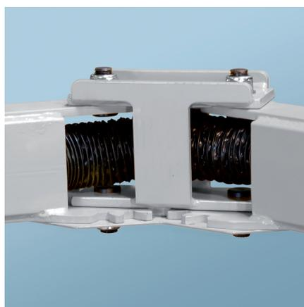
Guidage sécuritaire du bras articulé grâce à un système d'engrenages au fonctionnement fluide.
