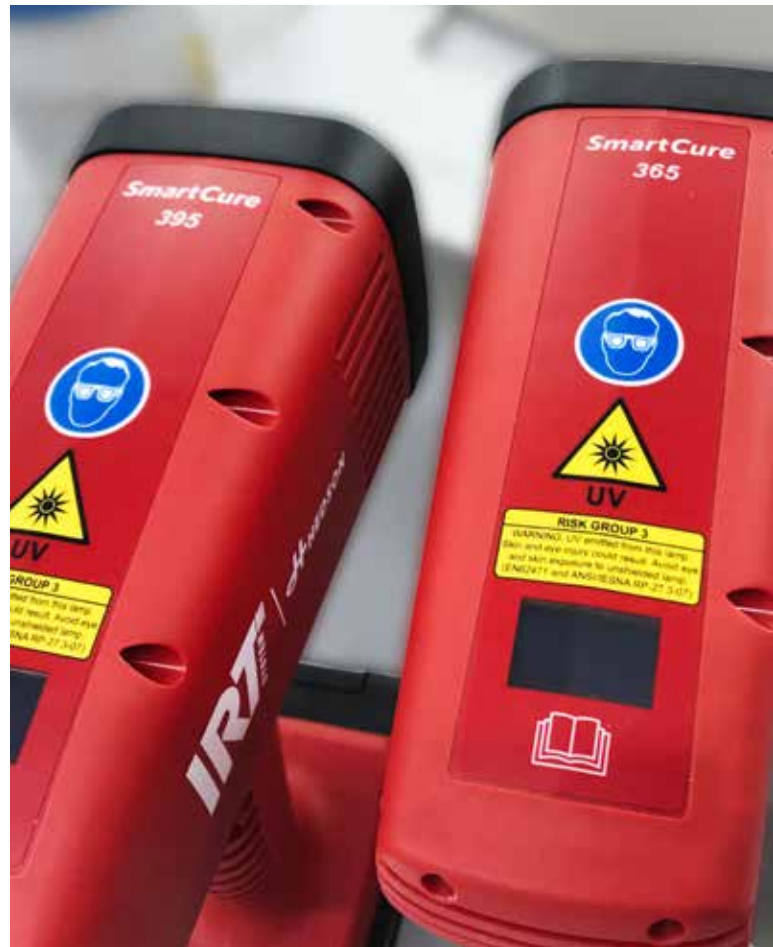
SmartCure ist mit Wellenlängen von 365 und 395 nm erhältlich, je nach den Anforderungen des Lackherstellers. Das System ermöglicht künftige Anpassungen und kann von 395 nm auf 365 nm nachgerüstet werden.
