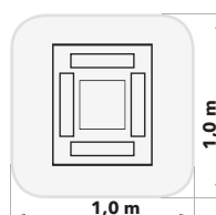
IRT COMBI 4-1 IR-UVA 1 kasetka w odległości 550 mm z intensywnością UVA 25 mW/cm 2
