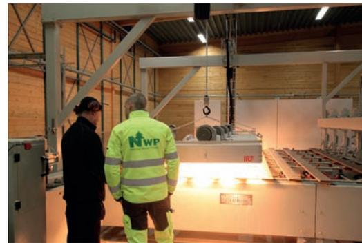
**CHAUFFAGE ADHÉSIF IRT** Les SingleHeaters IRT sont utilisés pour durcir la colle sur les rails pour assurer une adhérence parfaite et un processus plus rapide.
