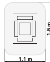
IRT COMBI 4-1 IR-UVA 1 casete a una distancia de 600 mm, en chapa negra
