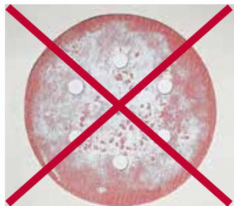
Trotz längerer Trocknungszeiten mit herkömmlichen Trocknern ist lediglich die Oberfläche trocken und das Schleifpapier verstopft.
