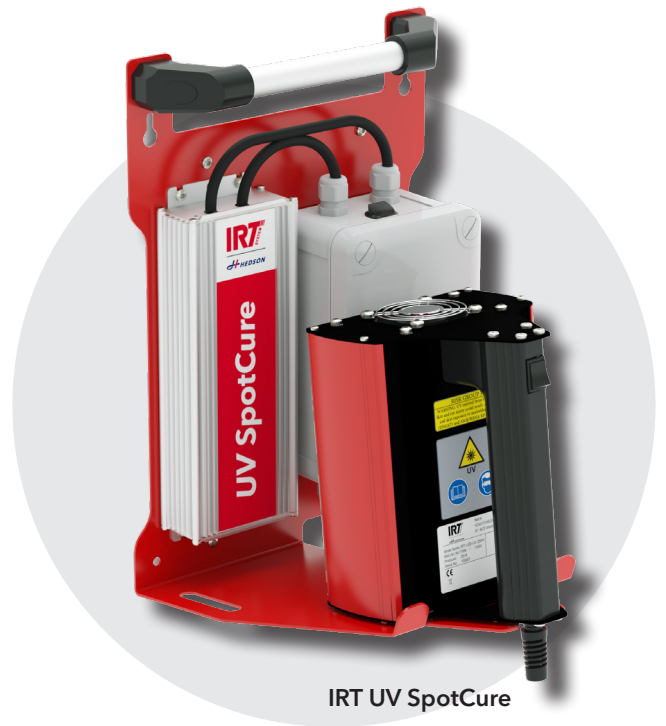
Utrustad med fyra 100W LED moduler och säkerhetsglas. Glaset skyddar LED från damm och spraypartiklar som resulterar i betydande prestandaförlust.
