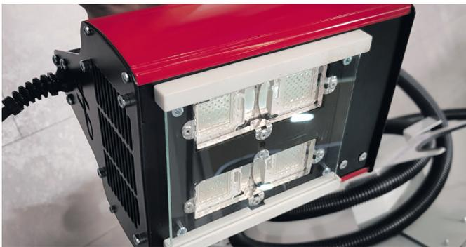
Équipé de quatre modules LED 100W et d'un verre de protection. Le verre prévient de toute dépose de poussière ou brouillard d'application sur les LED, qui risquerait d'entraîner une baisse de performance du sècheur.
