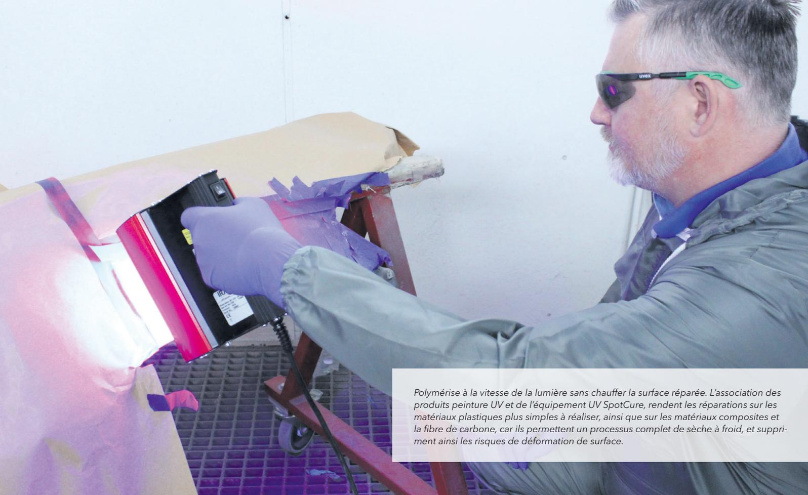
*Polymérise à la vitesse de la lumière sans chauffer la surface réparée. L'association des produits peinture UV et de l'équipement UV SpotCure, rendent les réparations sur les matériaux plastiques plus simples à réaliser, ainsi que sur les matériaux composites et la fibre de carbone, car ils permettent un processus complet de sèche à froid, et suppriment ainsi les risques de déformation de surface.*
