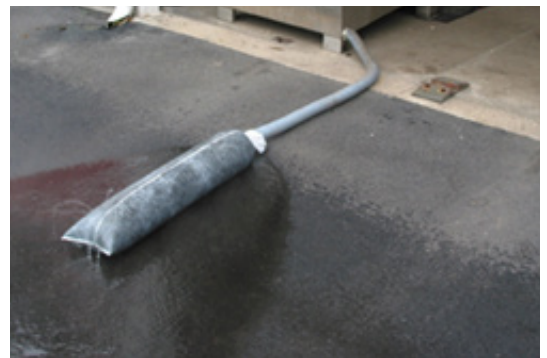
Vattnet rinner ur maskinen genom slang och filter.
