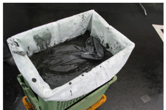
Den Bodenschlamm in den Filterkorb geben.
