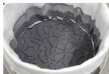
Torra avfallsrester töms enkelt ut ur filtret.
