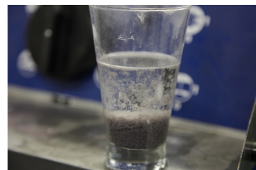
Färg som separeras genom flockning.
