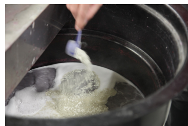
Flockuleringspulver strös i smutsvattnet.
