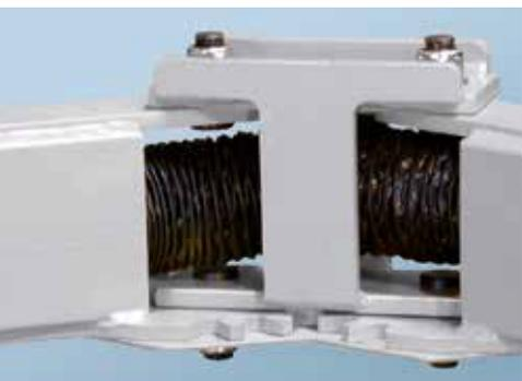
Guía de seguridad de los brazos giratorios a través de una conexión fluida de coronas dentadas.
