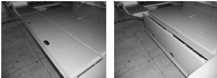
*Bild 8:* Zwischenfahrbahn in Grundstellung / Zwischenfahrbahn abgeklappt.
