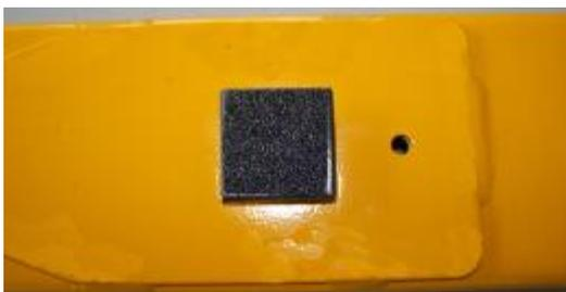
Den kleinen schwarzen Klotz wieder in den Arm einsetzen und im Anschluss diesen wieder in die Bühne einsetzen.
