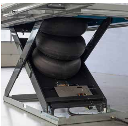
Kärnan i varje pneumatisk lyft - luftbälgen
