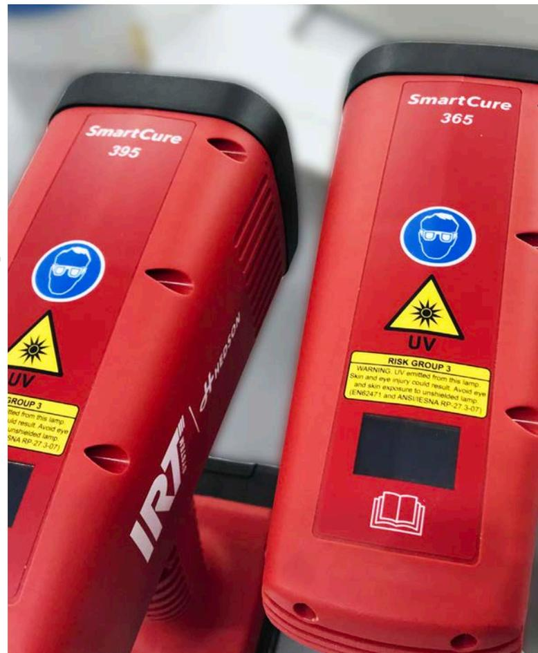
SmartCure est disponible avec des longueurs d'ondes de 365/395 nm, selon les spécifications du fabricant de peinture. Il est préparé pour des adaptations ultérieures et peut être modifié par la suite de 395 nm à 365 nm.
