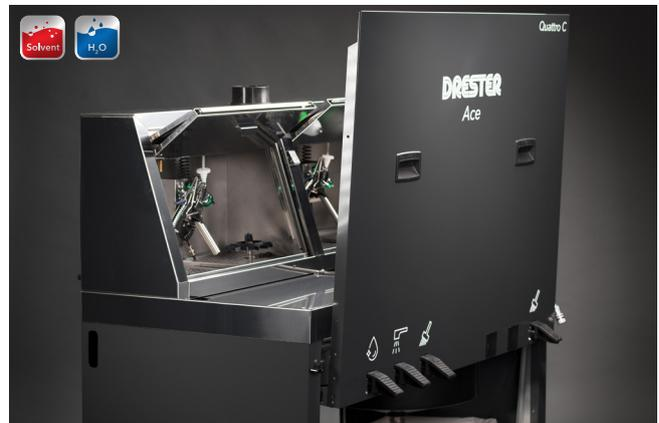
Le capot avant coulisse vers le haut et se remet en position de service pour un accès facile aux réservoirs de solvant / eau.
