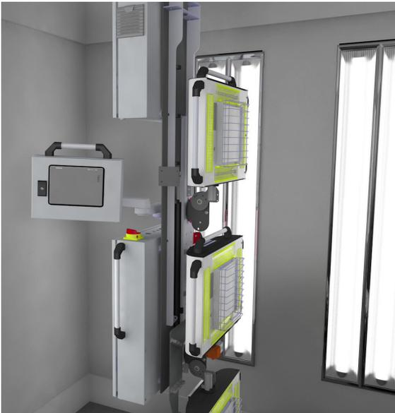
Roboterbewegung und automatisiertes Aushärten auf der langen oder kurzen Seite
