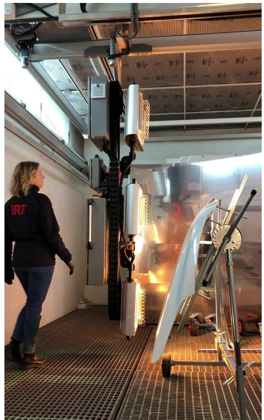
*\*Es ist kein Bogen und kein Halbbogen. Es ist ein Schienensystembasiertes, neues, kompaktes I-förmiger Roboter-COMBI-Gerät für IR- und UV-Lack-Härtung.\**
