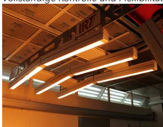
3 IR-Lampen/Zone mit einer Gesamtleistung von 38 kW.
