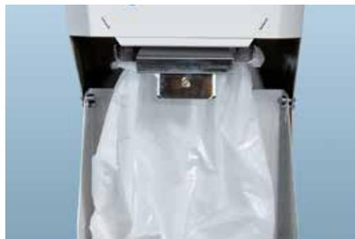
Eliminación del polvo ergonómica y con una menor generación de polvo mediante una placa deslizante y los soportes de la bolsa de polvo.
