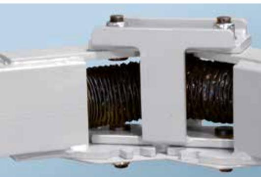
Guía de seguridad de los brazos giratorios a través de una conexión fluida de coronas dentadas.
