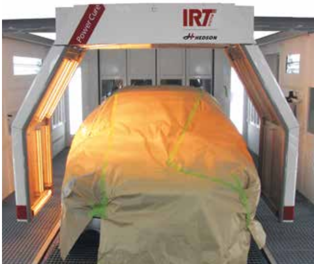
Standardhöhe des IRT PowerCure von Hedson (optional: Flügelverlängerung +200 mm)
